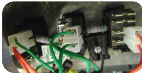
1 resistor de 220 OHMS entre cada botão
