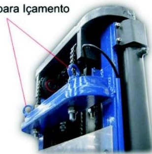
Pontos para içamento
